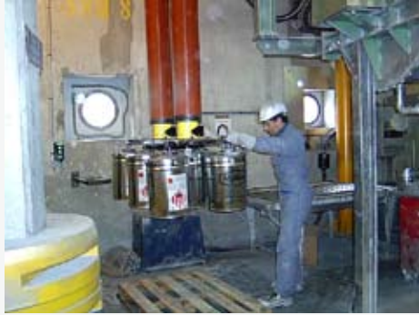
1. Der VM2200 mit Spezialsaugfuß hebt gleichzeitig acht Behälter, die mit chemischen Substanzen gefüllt sind.
