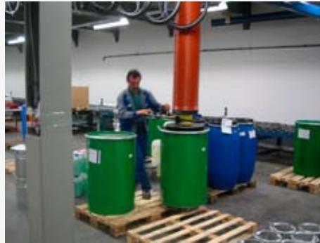
2. Dieses Bild zeigt den VM300 Fassheber. Der verwendete Saugfuß hat die ProjektNr.: 1929.
