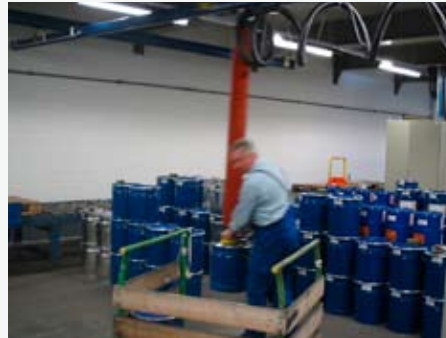
3. Die Handhabung von Fässern mit einem ca. Gewicht von 60 kg ist ein Kinderspiel mit dem VacuEasylift VM160. Der Saugfuß dieser Einheit stammt aus dem Standardsortiment und hat die Artikelnr.: 610230.
